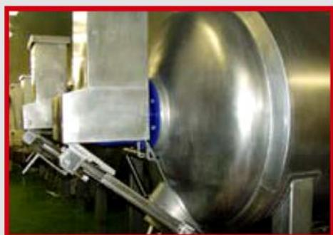
Takto nasolená surovina se pak v tumbleru namasíruje – díky působení mechanických sil je pak maso křehčí a lák se dokonale rozptýlí a výrobek je pak šťavnatý a rovnoměrně vybarvený.
